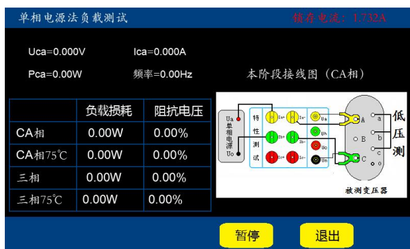
图十六-3 单相电源负载测试 CA 相测完
