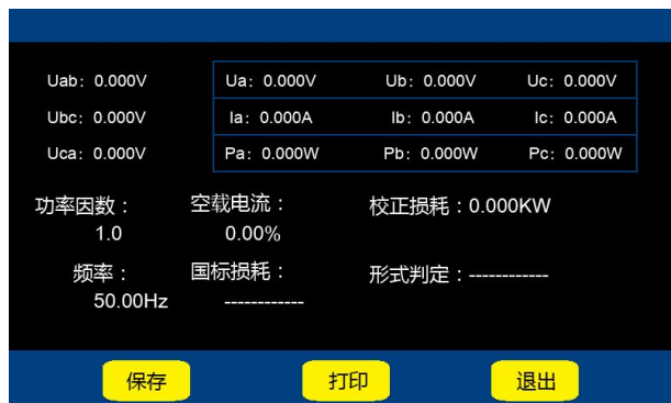
图八-2 三瓦特法空载测试结果
