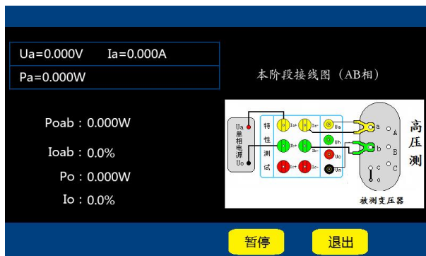
图十-1 单相电源空载测试 AB 相
