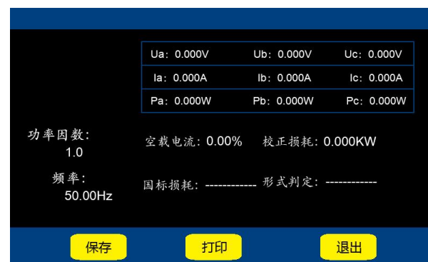
图十-4 单相电源空载测试最终计算结果
