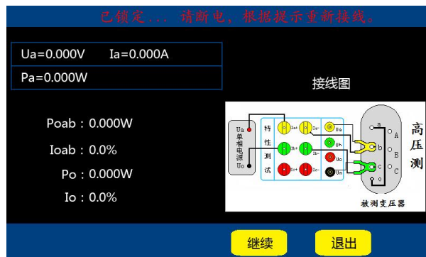
图十-2 单相电源空载测试 BC 相接线
