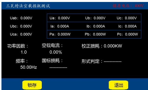
图八-1 三瓦特法空载测试中
