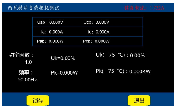
图十四-1 两瓦特法负载损耗测试
