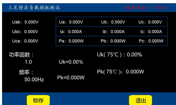
图十三-1 三瓦特法负载损耗测试
