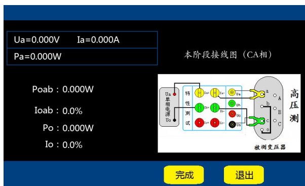
图十-3 单相电源空载测试 CA 相测完
