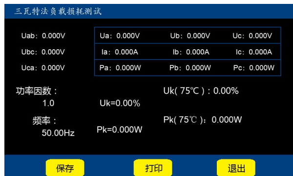
图十三-2 三瓦特法负载损耗测试结果
