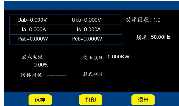
图九-2 两瓦特法空载测试结果
